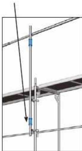
Joon. 21 ja 22: Eelneva kaitsepiirde posti ühendamine Speedy Frame külge
