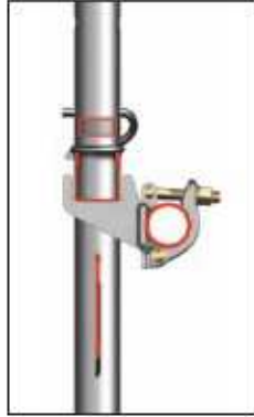
Joon. 52: Seinakinniti ühendus läbilõikes
