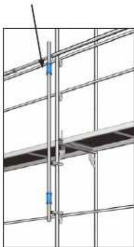
Joon. 21 ja 22: Eelneva kaitsepiirde posti ühendamine Speedy Frame külge
